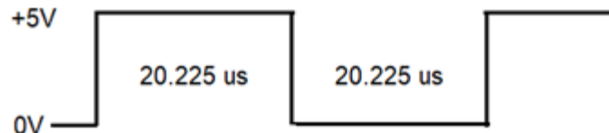
Figura N° 9: Función voltaje tiempo de un tren de pulsos [Fuente: Ing. Civil Electrónico G. Sanhueza G.]
