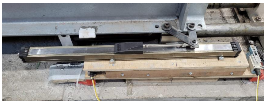
Fig.2.5: LVDT Ingeniería Civil.
