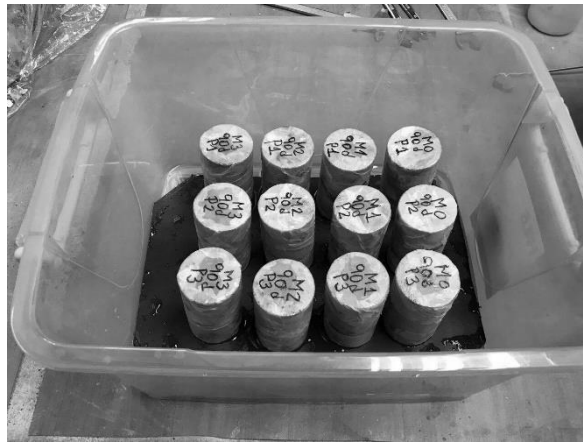
Figura 8. Almacenamiento de probetas remoldeadas durante el período de curado para ser ensayadas a compresión no confinada.
