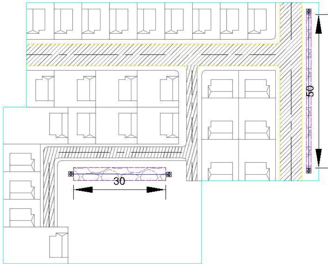
Figura 9: Ubicación y largo de las zanjas.
