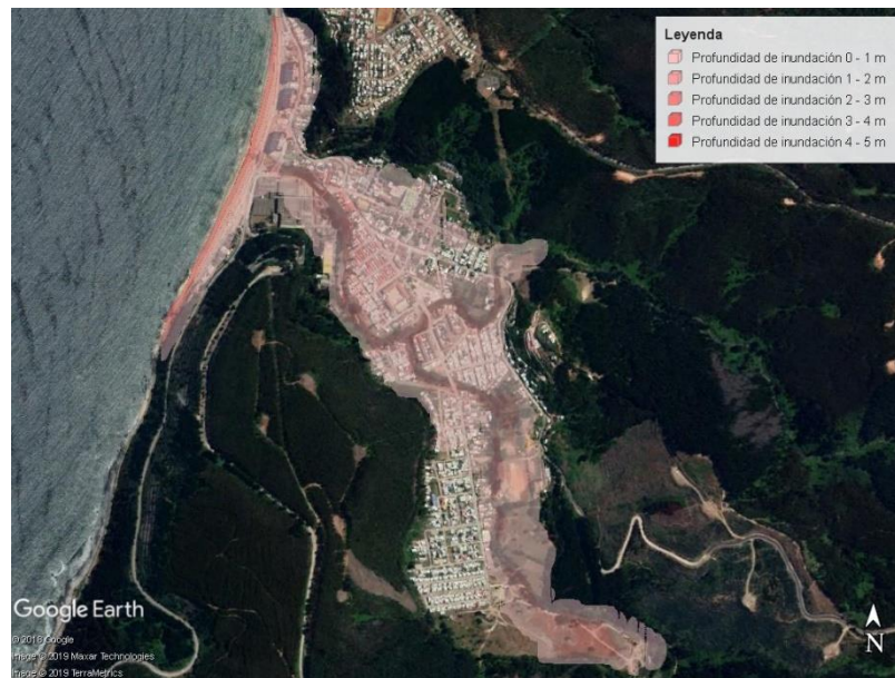
Figura 9. Mapa de inundación, con 75% de probabilidad de excedencia, periodo de retorno medio conjunto según recurrencia sísmica de Gutenberg - Richter 5,007 años y según recurrencia sísmica histórica de 667 años.
