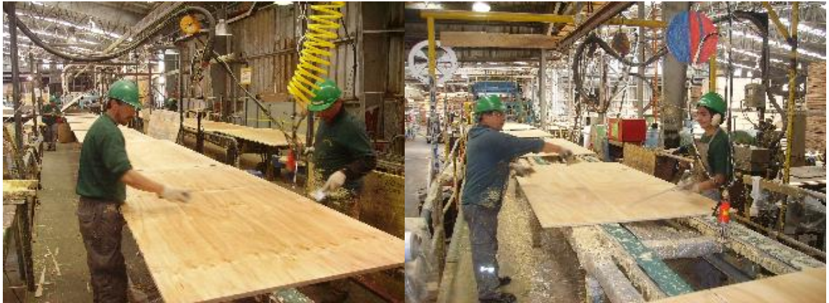
Figura 15: proceso de “retape de tableros” 11
