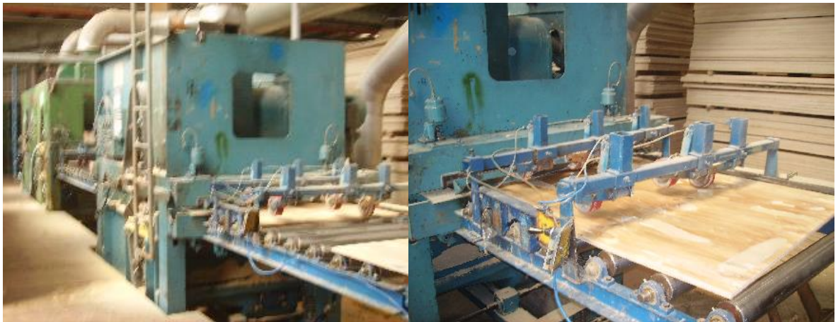
Figura 16: proceso de lijado del tablero.
