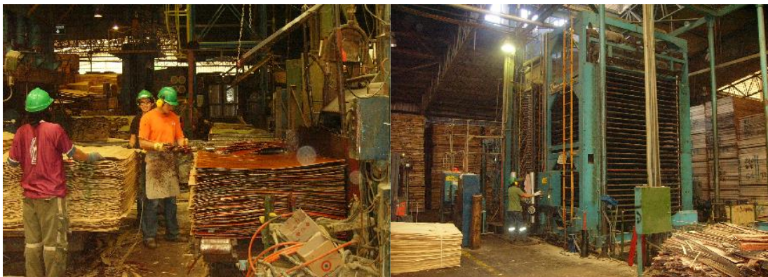
Figura 11: armado y prensado de tableros
