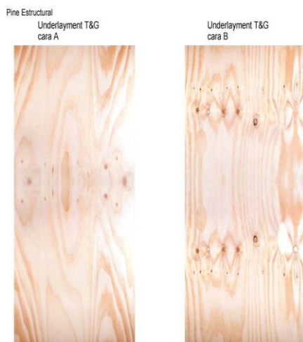
Figura 9: tablero calidad AB
