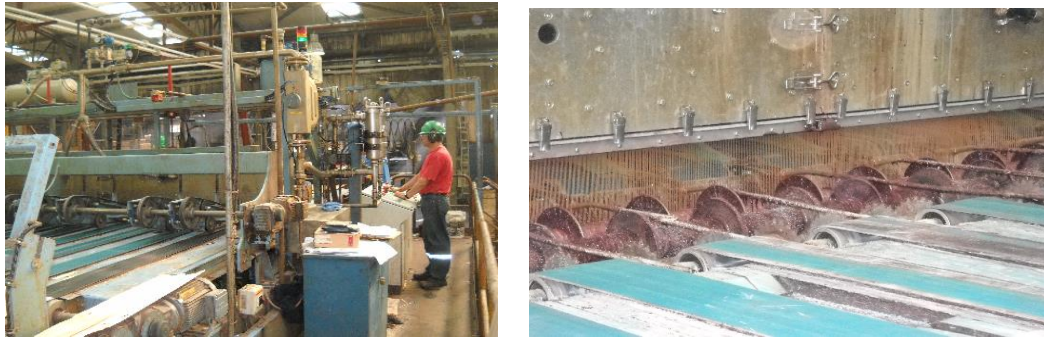
Figura 13: encoladora extrusión, y líneas presurizadas de aplicación de adhesivo El siguiente diagrama muestra el proceso de fabricación de tableros en la prensa.
