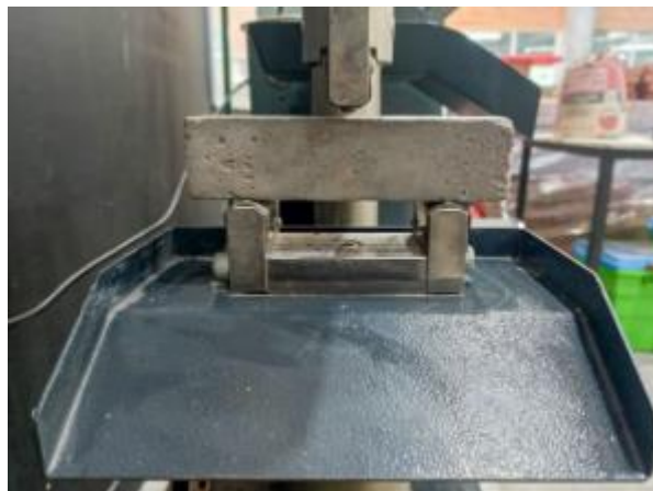
Figura 8: Probeta dispuesta para ensayo de flexión. Fuente: Elaboración propia.
