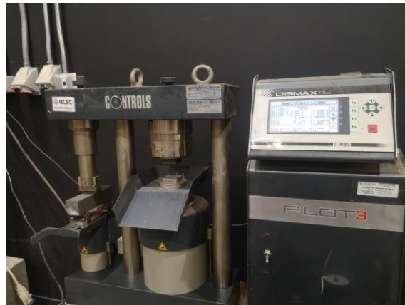
Figura 7: Prensa de compresión Pilot 3, marca Controls, modelo 65 – L11G2/C. Fuente: Elaboración propia.
