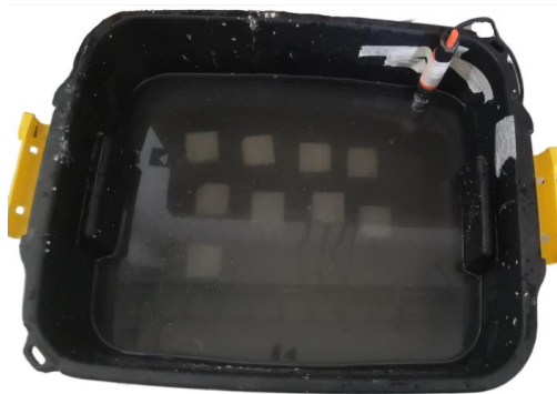
Figura 6: Cubeta para curado de probetas, contiene las probetas, agua y un termo calefactor. Fuente: Elaboración propia.
