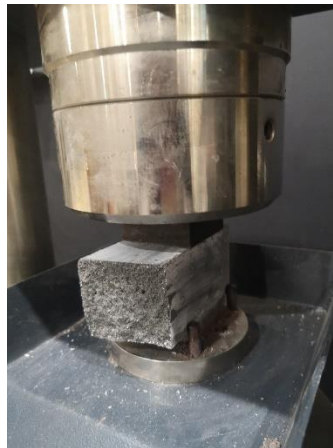
Figura 9: Probeta dispuesta para ensayo de compresión. Fuente: Elaboración propia.
