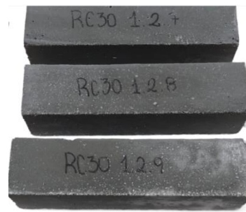
Figura 5: Probetas desmoldadas después de fraguado. Fuente: Elaboración propia.
