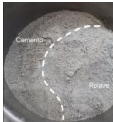
Figura 2: Cemento y relave de cobre antes de mezclar.
