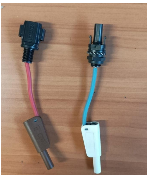
Fig. 3.13. Conectores de enlace.
