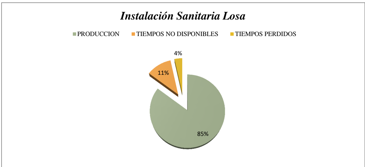
Figura 4.18 Clasificación de tiempos en la instalación sanitaria en losa del edificio.
