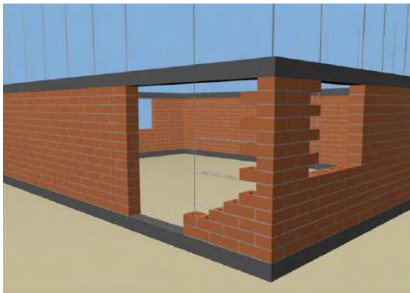
Figura 2.2: Albañilería armada (Manual del albañil del ICH).
