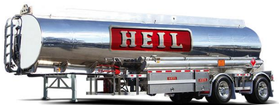
Fig. 5: Semirremolque estanque aluminio para combustible Fuente: www.Kauffman.cl
