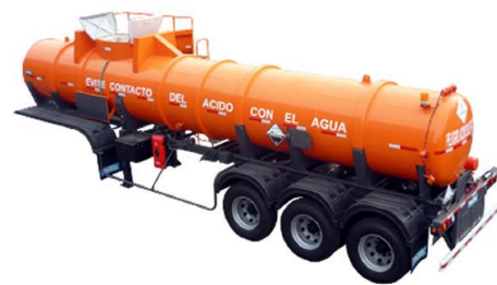
Fig. 6: Semirremolque estanque revestido para ácido Fuente: www.Kauffman.cl
