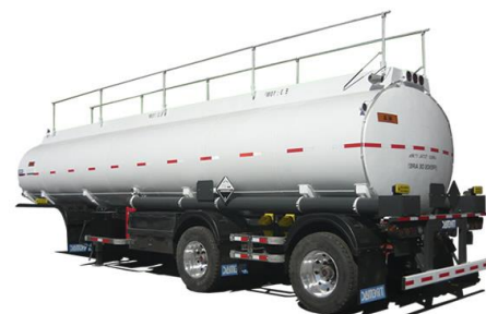
Fig. 8: Semirremolque estanque acero para combustible Fuente: www.Kauffman.cl
