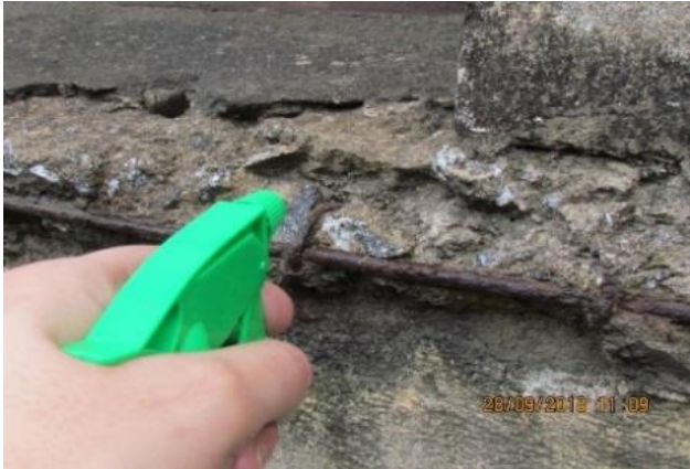
a) Aplicación de disolución de fenolftaleína.
