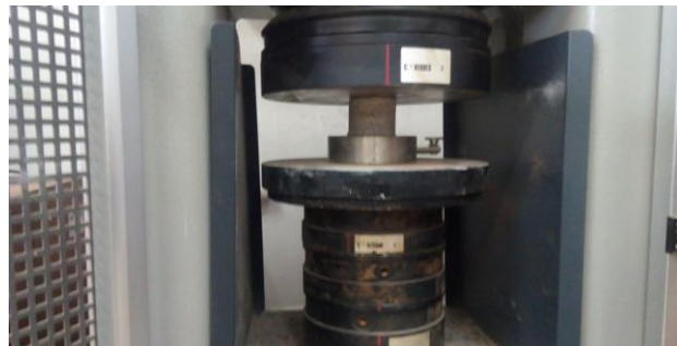
Figura 19: Ensayo de compresión testigo proveniente escuela Bellavista.
