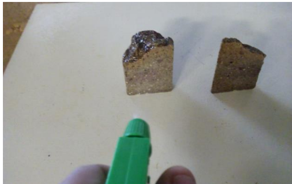
a) Aplicación de disolución de fenolftaleína.
