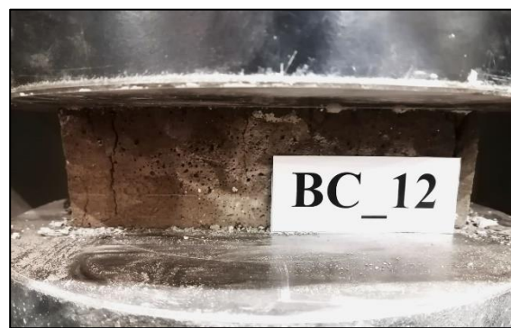
Figura A.6.17.12. Probeta BC_12 máx. compresión.
