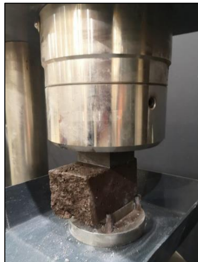
Figura 10: Espécimen en ensayo de compresión. (Fuente: Elaboración propia).
