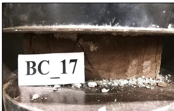
Figura A.6.17.16. Probeta BC_17 máx. compresión.
