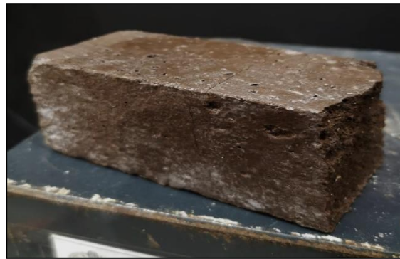
Figura A.6.14.6. Probeta D-BC40-3.2 máx. compresión.
