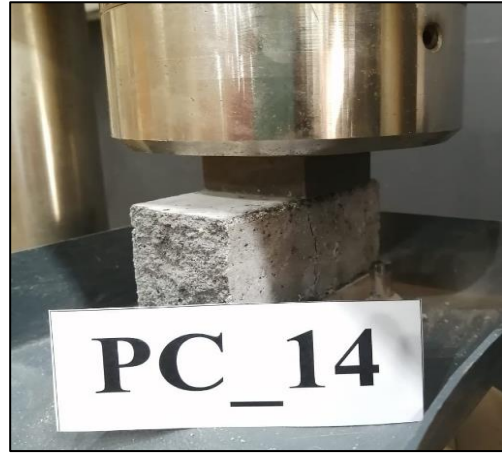
Figura A.6.18.14. Probeta PC_14 máx. compresión.
