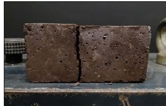
Figura A.6.13.4. Probeta D-BC40-2.2 máx. compresión.
