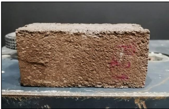
Figura A.6.4.3. Probeta D-BC10-2.1 máx. compresión.
