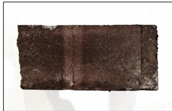
Figura A.6.10.2. Probeta D-BC30-2.1 máx. compresión.
