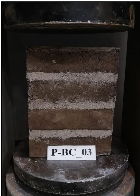
Figura A.6.20.3. Prisma P-BC_03 en ensayo compresión.
