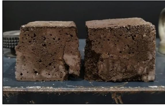
Figura A.6.7.2. Probeta D-BC20-1.2 máx. compresión.
