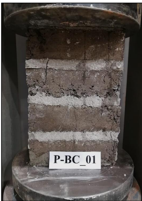
Figura A.6.20.1. Prisma P-BC_01 máx. compresión.
