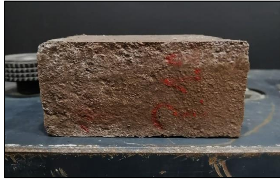
Figura A.6.4.2. Probeta D-BC10-1.2 máx. compresión.
