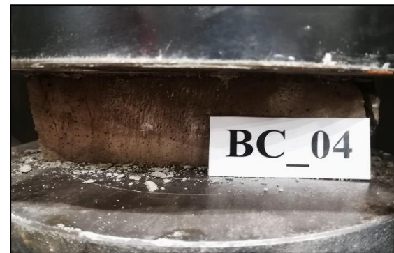
Figura A.6.17.4. Probeta BC_04 máx. compresión.
