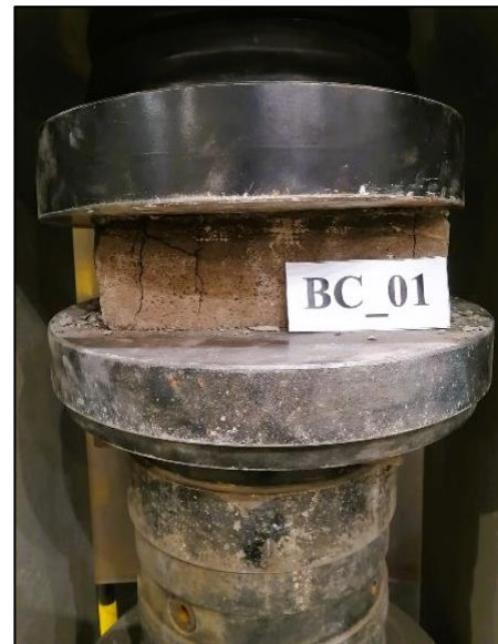
Figura 13: Adocreto BC_01 después de ensayo. (Fuente: Elaboración propia).
