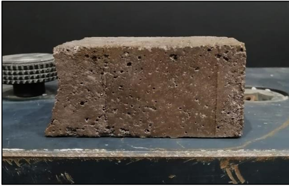
Figura A.6.4.1. Probeta D-BC10-1.1 máx. compresión.
