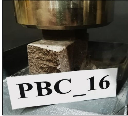
Figura A.6.19.12. Probeta PBC_16 máx. compresión.
