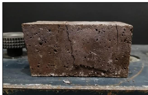
Figura A.6.13.2. Probeta D-BC40-1.2 máx. compresión.
