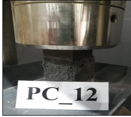
Figura A.6.18.12. Probeta PC_12 máx. compresión.
