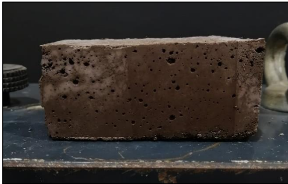
Figura A.6.7.4. Probeta D-BC20-2.2 máx. compresión.
