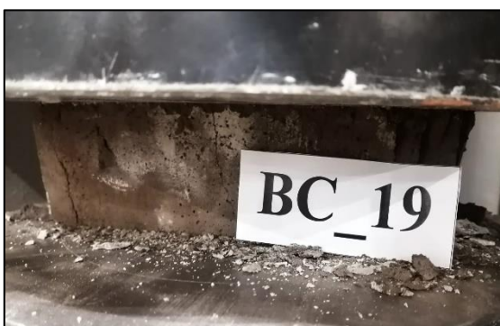
Figura A.6.17.17. Probeta BC_19 máx. compresión.
