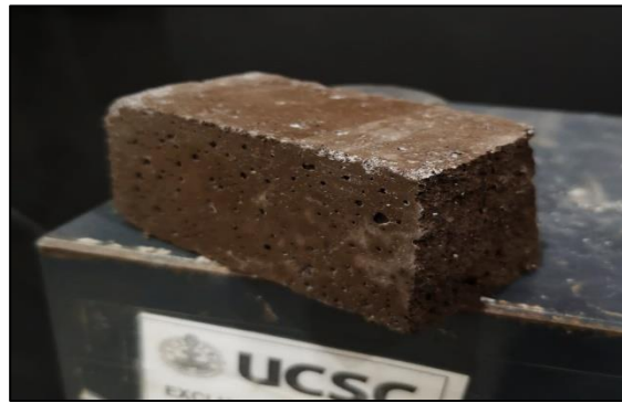
Figura A.6.14.4. Probeta D-BC40-2.2 máx. compresión.
