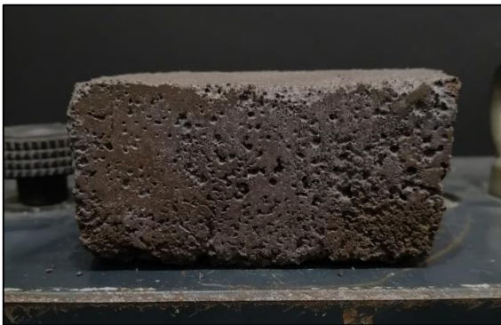
Figura A.6.5.1. Probeta D-BC10-1.1 máx. compresión.
