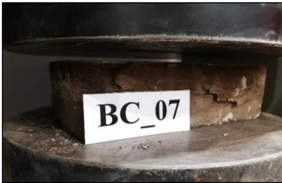
Figura A.6.17.7. Probeta BC_07 máx. compresión.
