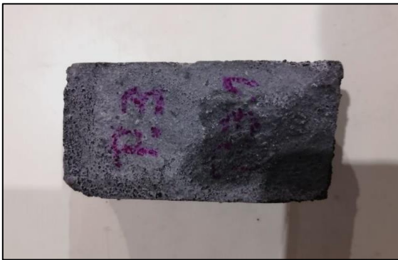
Figura A.6.1.5. Probeta DN-3.1 máx. compresión.
