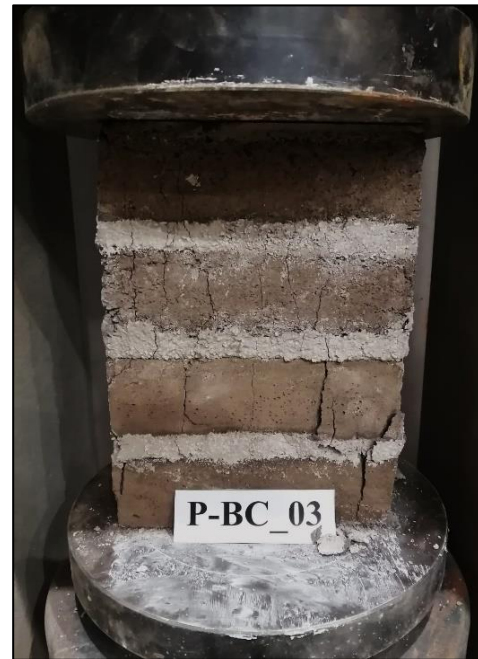
Figura A.6.20.4. Prisma P-BC_03 máx. compresión.
