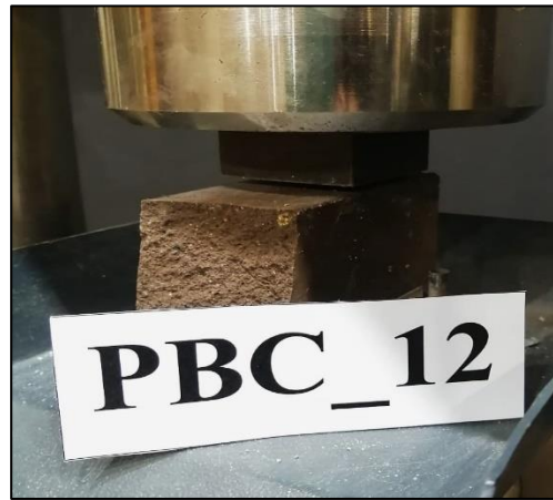
Figura A.6.19.10. Probeta PBC_12 máx. compresión.
