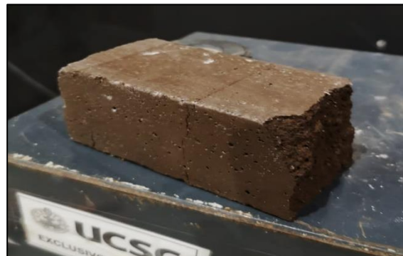
Figura A.6.14.2. Probeta D-BC40-1.2 máx. compresión.
