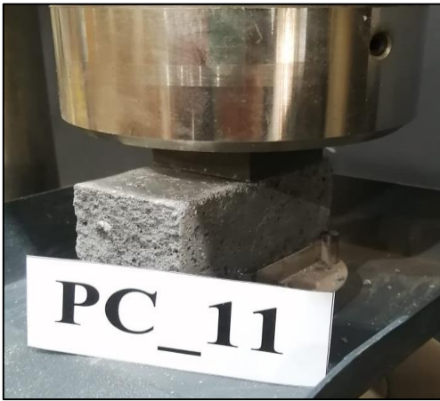
Figura A.6.18.11. Probeta PC_11 máx. compresión.
