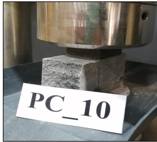
Figura A.6.18.10. Probeta PC_10 máx. compresión.
