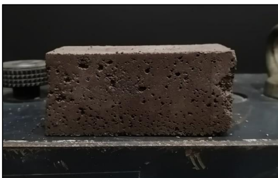
Figura A.6.4.6. Probeta D-BC10-3.2 máx. compresión.
