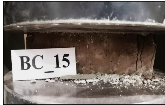
Figura A.6.17.14. Probeta BC_15 máx. compresión.
