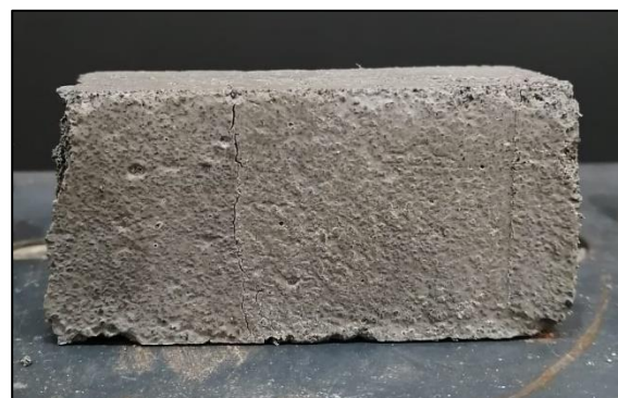
Figura A.6.2.2. Probeta DN-1.2 máx. compresión.
