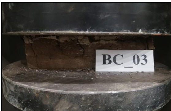
Figura A.6.17.3. Probeta BC_03 máx. compresión.
