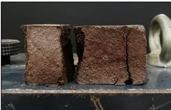
Figura A.6.7.5. Probeta D-BC20-3.1 máx. compresión.
