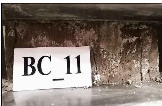
Figura A.6.17.11. Probeta BC_11 máx. compresión.
