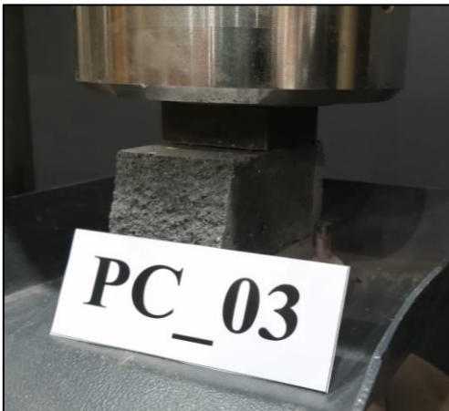
Figura A.6.18.3. Probeta PC_03 máx. compresión.
