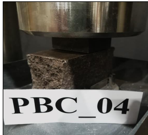
Figura A.6.19.4. Probeta PBC_04 máx. compresión.
