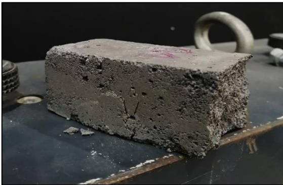
Figura A.6.1.1. Probeta DN-1.1 máx. compresión.
