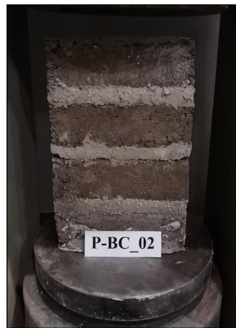
Figura A.6.20.2. Prisma P-BC_02 máx. compresión.
