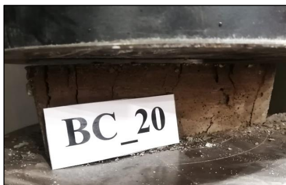
Figura A.6.17.18. Probeta BC_20 máx. compresión.
