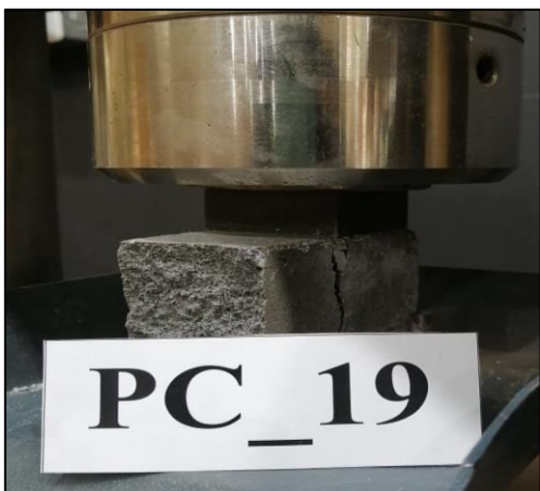
Figura A.6.18.19. Probeta PC_19 máx. compresión.
