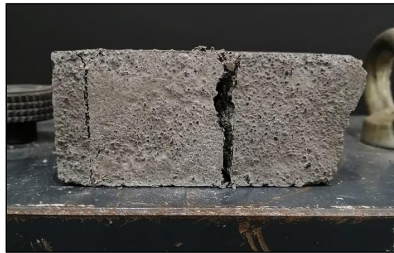
Figura A.6.2.3. Probeta DN-1.3 máx. compresión.
