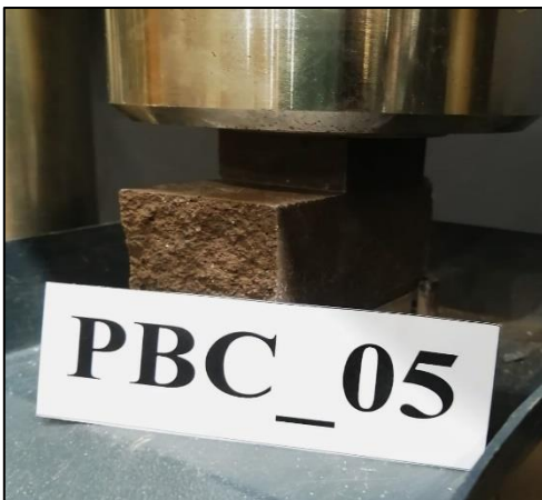
Figura A.6.19.5. Probeta PBC_05 máx. compresión.
