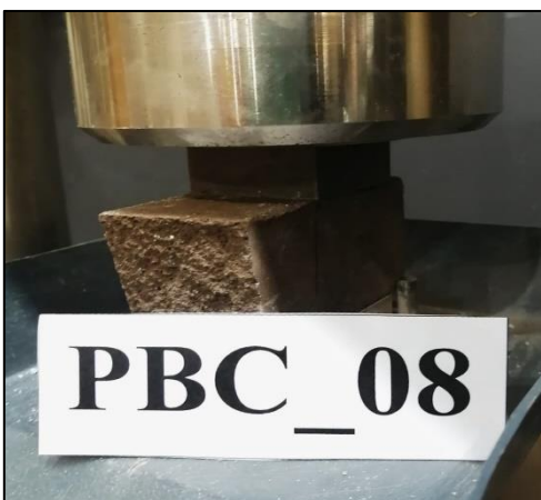
Figura A.6.19.7. Probeta PBC_08 máx. compresión.
