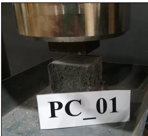
Figura A.6.18.1. Probeta PC_01 máx. compresión.
