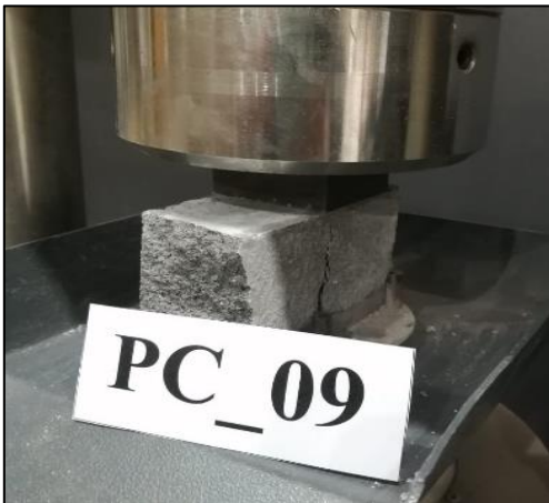
Figura A.6.18.9. Probeta PC_09 máx. compresión.
