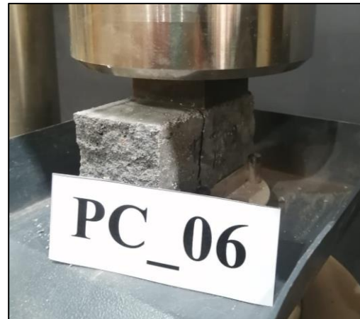
Figura A.6.18.6. Probeta PC_06 máx. compresión.
