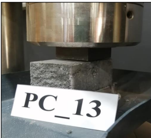
Figura A.6.18.13. Probeta PC_13 máx. compresión.
