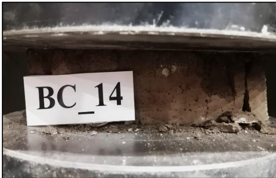
Figura A.6.17.13. Probeta BC_14 máx. compresión.
