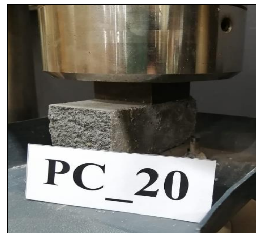
Figura A.6.18.20. Probeta PC_20 máx. compresión.
