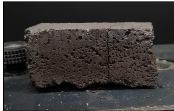
Figura A.6.5.2. Probeta D-BC10-2.1 máx. compresión.
