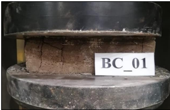
Figura A.6.17.1. Probeta BC_01 máx. compresión.
