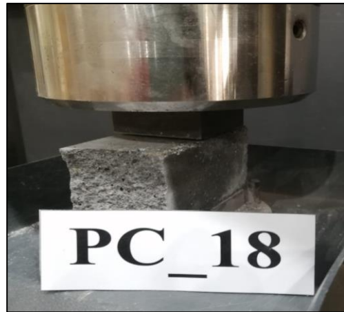
Figura A.6.18.18. Probeta PC_18 máx. compresión.
