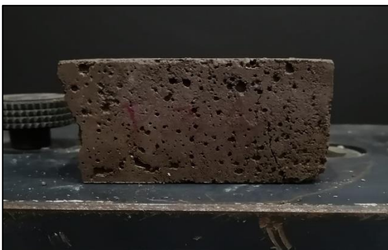
Figura A.6.4.5. Probeta D-BC10-3.1 máx. compresión.
