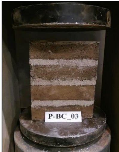
Figura 14: Prisma P-BC_03 antes de ensayo. (Fuente: Elaboración propia).
