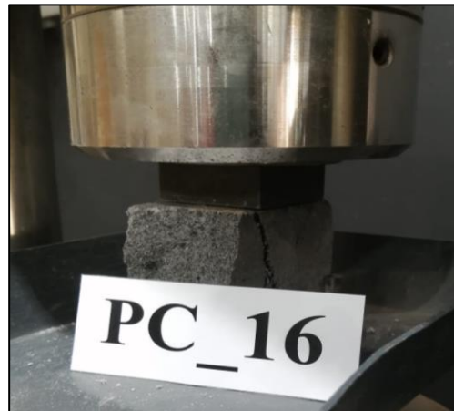
Figura A.6.18.16. Probeta PC_16 máx. compresión.
