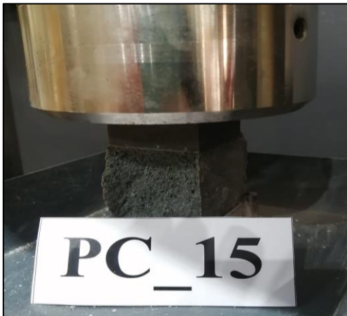
Figura A.6.18.15. Probeta PC_15 máx. compresión.
