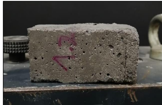
Figura A.6.1.2. Probeta DN-1.2 máx. compresión.
