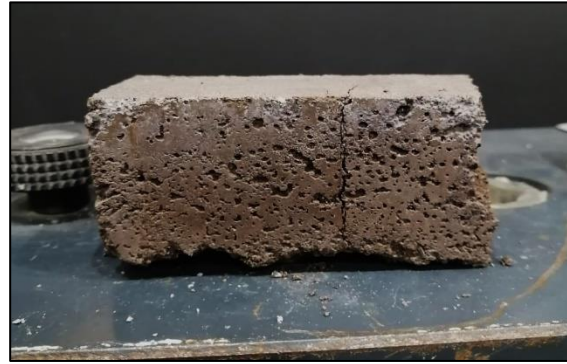
Figura A.6.13.6. Probeta D-BC40-3.2 máx. compresión.
