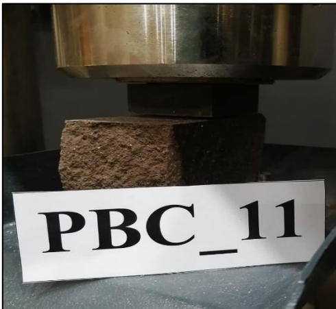
Figura A.6.19.9. Probeta PBC_11 máx. compresión.
