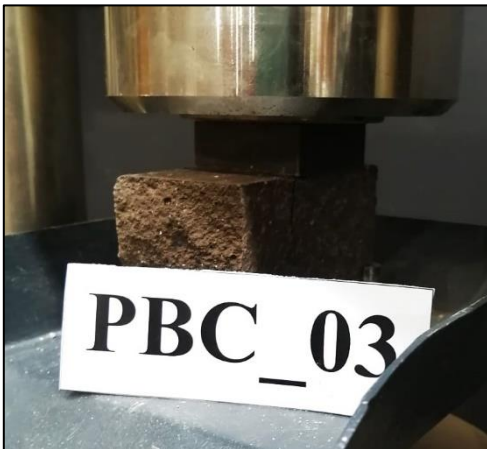
Figura A.6.19.3. Probeta PBC_03 máx. compresión.
