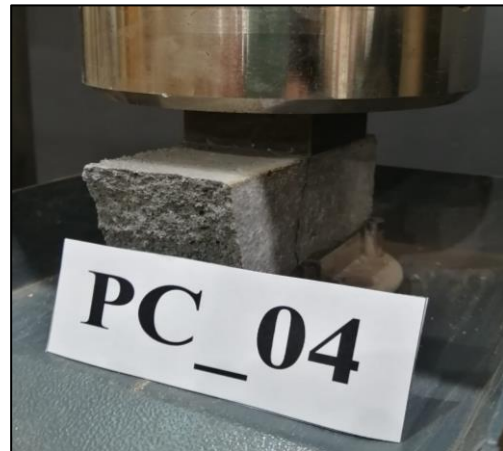
Figura A.6.18.4. Probeta PC_04 máx. compresión.
