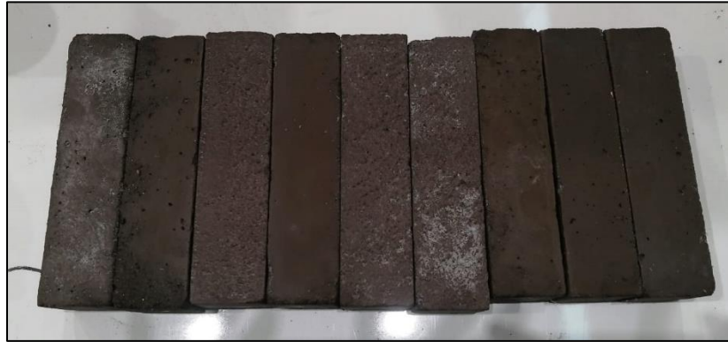
Figura 16: Set de probetas rilem con 20% reemplazo de barras conox. (Fuente: Elaboración propia).
