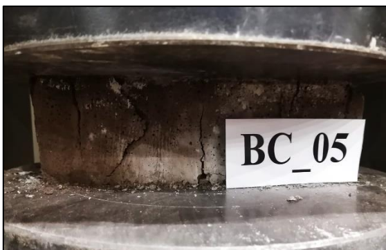
Figura A.6.17.5. Probeta BC_05 máx. compresión.
