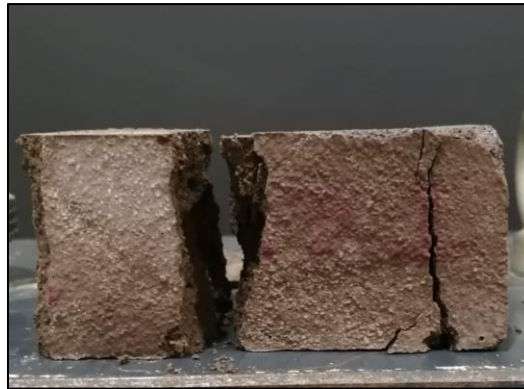
Figura 11: Espécimen con máxima compresión. (Fuente: Elaboración propia).
