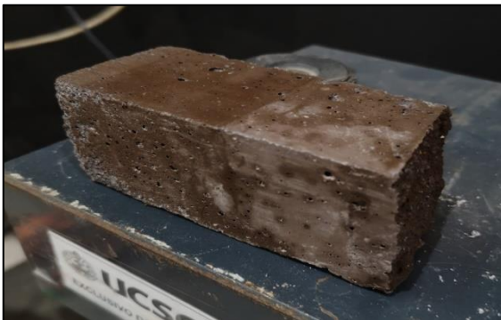
Figura A.6.14.1. Probeta D-BC40-1.1 máx. compresión.
