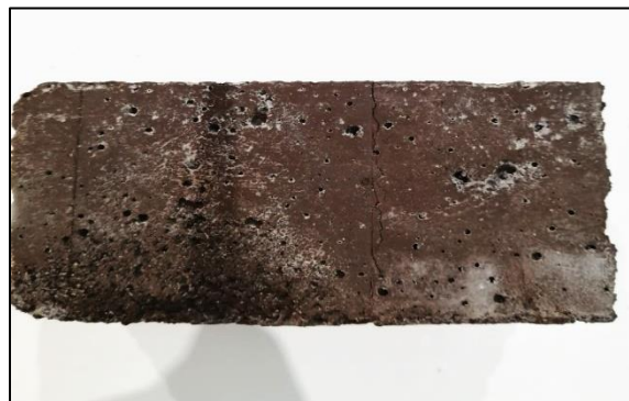
Figura A.6.10.3. Probeta D-BC30-3.1 máx. compresión.
