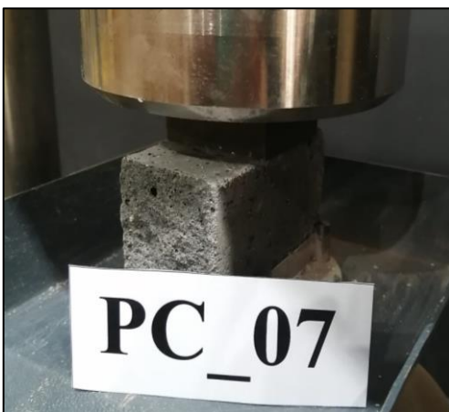
Figura A.6.18.7. Probeta PC_07 máx. compresión.
