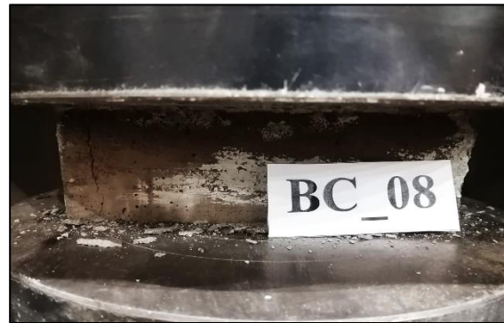
Figura A.6.17.8. Probeta BC_08 máx. compresión.
