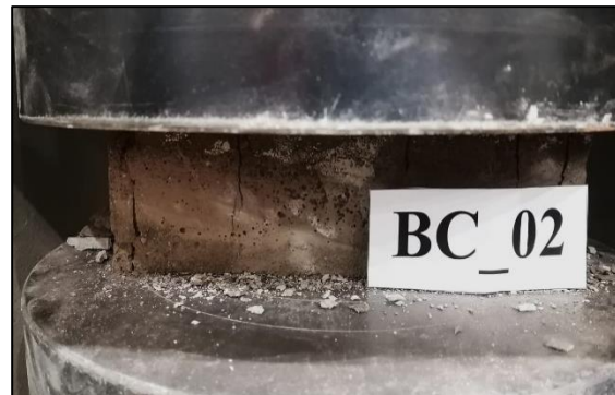
Figura A.6.17.2. Probeta BC_02 máx. compresión.
