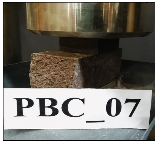
Figura A.6.19.6. Probeta PBC_07 máx. compresión.
