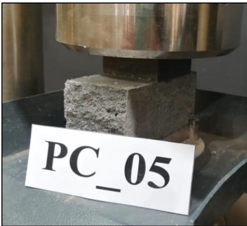
Figura A.6.18.5. Probeta PC_05 máx. compresión.
