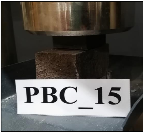
Figura A.6.19.11. Probeta PBC_15 máx. compresión.
