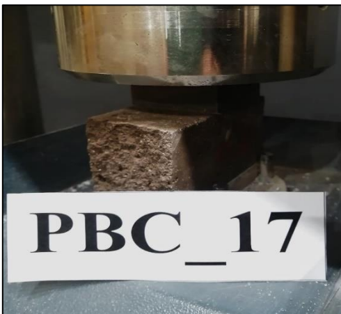
Figura A.6.19.13. Probeta PBC_17 máx. compresión.
