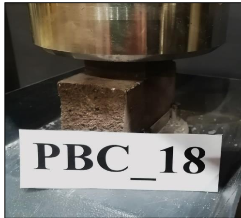
Figura A.6.19.14. Probeta PBC_18 máx. compresión.
