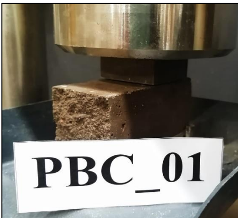
Figura A.6.19.1. Probeta PBC_01 máx. compresión.
