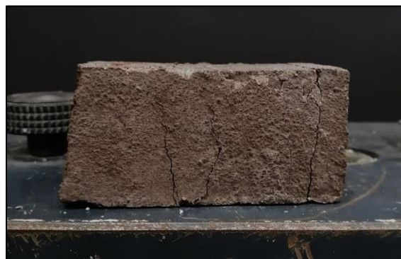
Figura A.6.5.3. Probeta D-BC10-3.1 máx. compresión.
