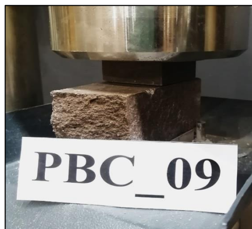
Figura A.6.19.8. Probeta PBC_09 máx. compresión.
