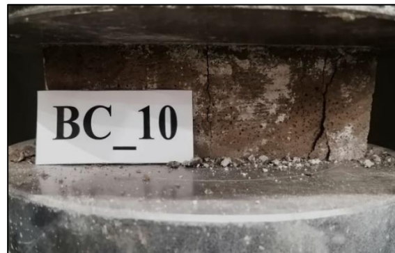
Figura A.6.17.10. Probeta BC_10 máx. compresión.
