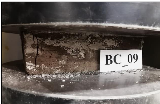
Figura A.6.17.9. Probeta BC_09 máx. compresión.
