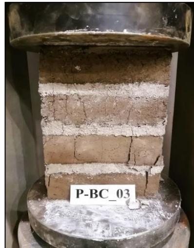
Figura 15: Prisma P-BC_03 posterior a ensayo. (Fuente: Elaboración propia).
