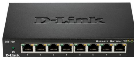
Fig. 2.35: Switch de Comunicación
