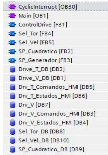
Fig. A.51: Listado de Bloques FB y DB de la Plataforma Experimental
