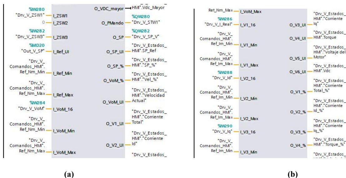
Fig. 4.22: Función Block ControlDrive Intermedio MCV
