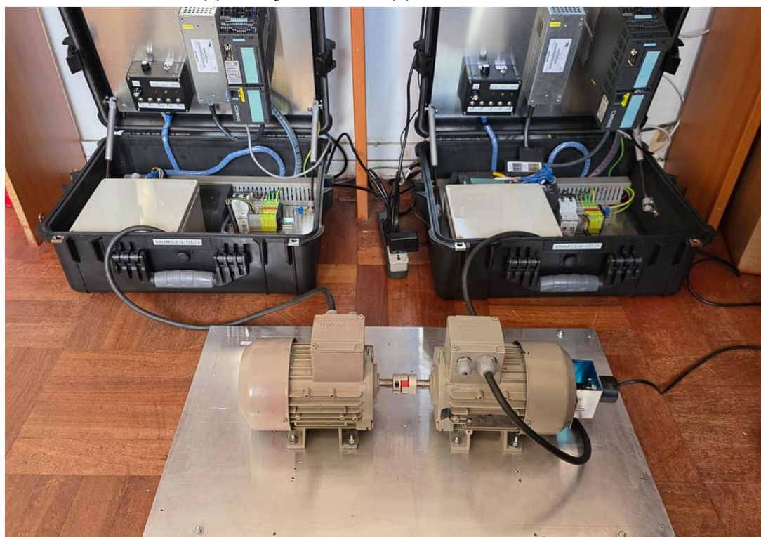
Fig. E.21: Conexión de motores a G120 01 y G120 02
