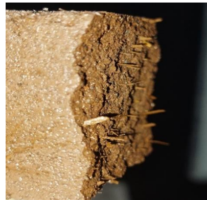
Figura 25: Espécimen 2 con fibra de paja. Fuente: Elaboración propia.
