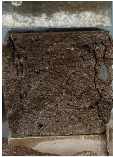
Figura 22: Sección transversal de espécimen de Barro Conox. Fuente: Elaboración propia.
