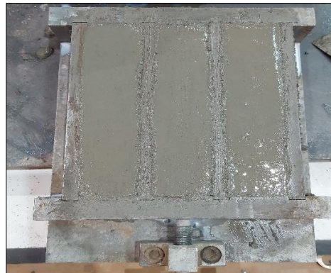
Figura 5: Especímenes fabricados en moldes Rilem. Fuente: Elaboración propia.
