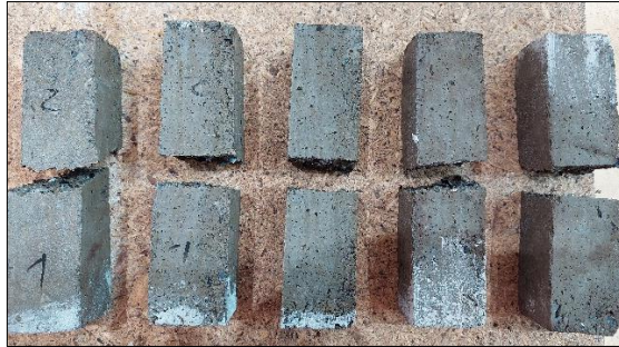
Figura 13: Muestra de especímenes previo a ensayo a compresión. Fuente: Elaboración propia.
