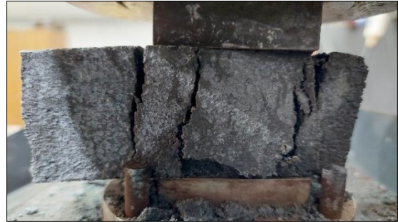
Figura 14: Espécimen ensayado a compresión. Fuente: Elaboración propia.
