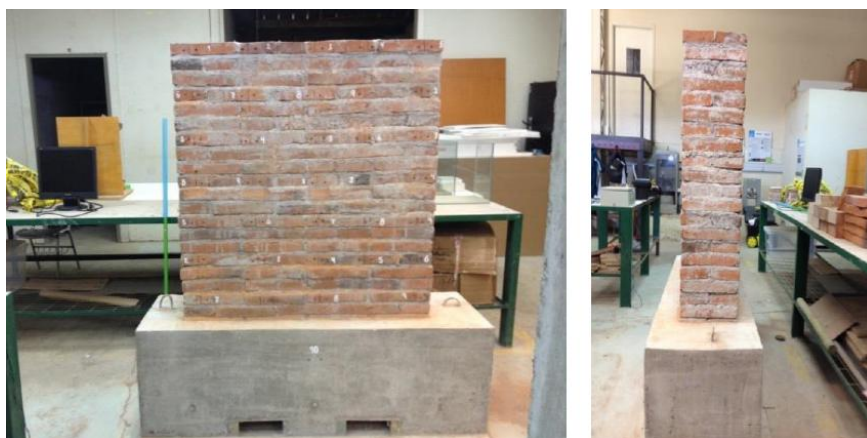
Figura 5: Muro de albañilería sin reforzar (Chávez, 2013).
