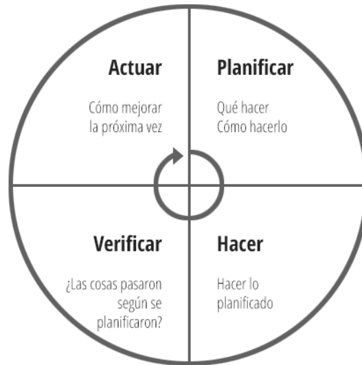
Figura 1: Funcionamiento del ciclo P-H-V-A, utilizado en los Sistemas de Gestión de la Calidad para la mejora continua de procesos.
