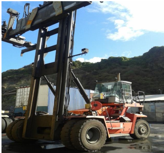
Imagen 4-2: Stackers Empty. Elaboración propia.
