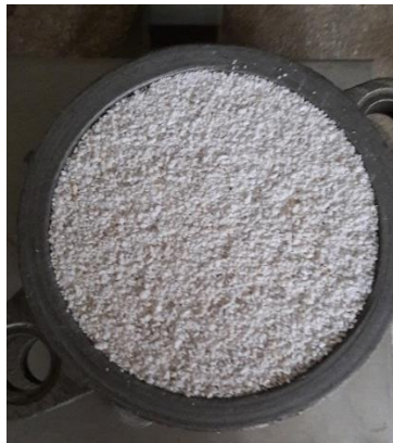
Ilustración 6: Molde + perlita, ensayo de densidad máxima y mínima.
