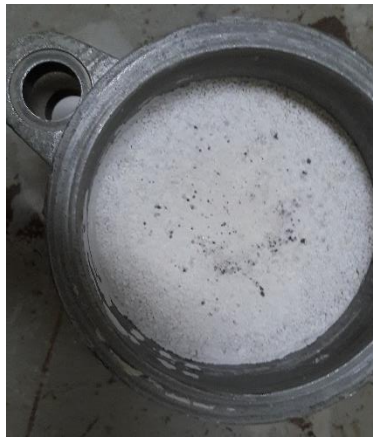
Imagen 3: Molde + perlita, descenso del volumen de perlita.
