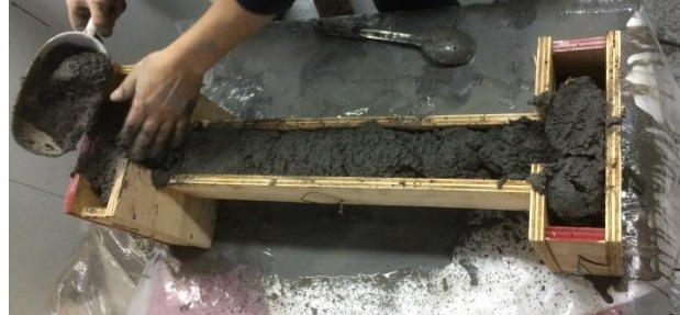
(b) Hormigonado y vibrado
