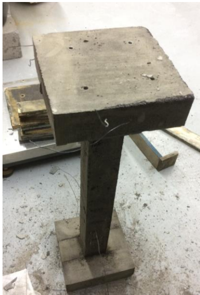
(c) Descimbre de las columnas
