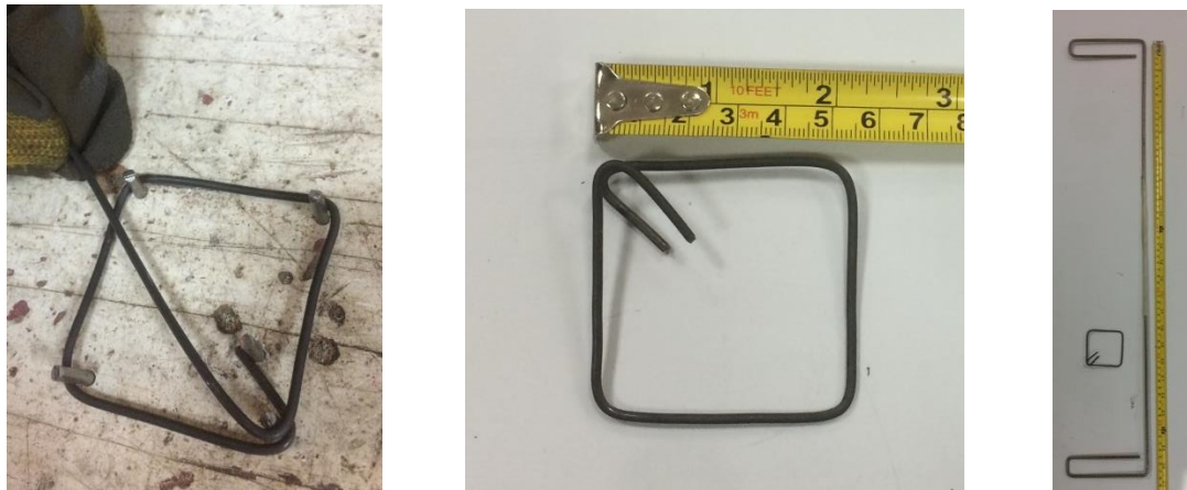
Fig. 6. Fabricación de estribos y armaduras longitudinales
