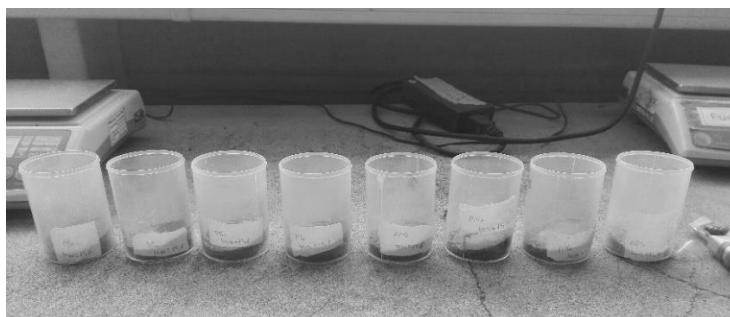
Figura 4: Muestras de suelo y escoria en diferentes proporciones para determinar su correspondiente pH. Fuente: Elaboración propia.
