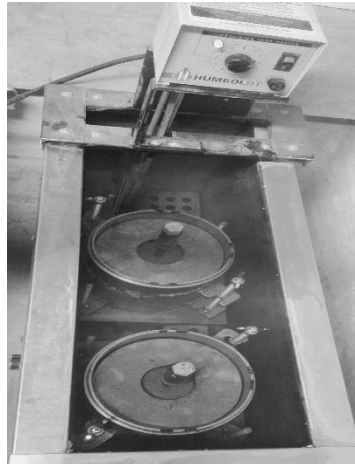
Figura 3: Moldes sumergidos durante ensayo de expansión potencial. Fuente: Elaboración propia.
