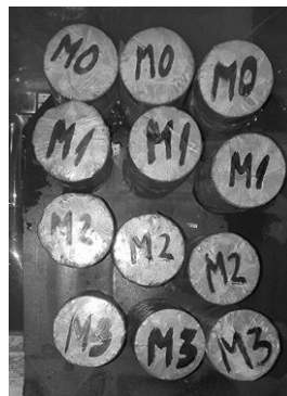
Figura 1: Almacenamiento de probetas remoldeadas para ensayo de CNC.
