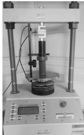
Figura 2: Ensayo de Compresión no Confinada, según ASTM D 2166. Fuente: Elaboración propia.
