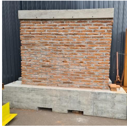
Figura 1: Muro de albañilería ensayado
