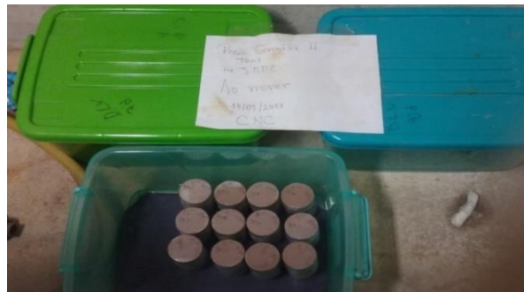
Figura 3: Almacenamiento de las probetas en el interior de cajas plásticas en la cámara húmeda para efectuar el periodo de curado.
