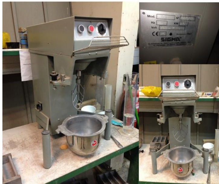
Figura 5. Mezcladora utilizada para realizar la mezcla.
