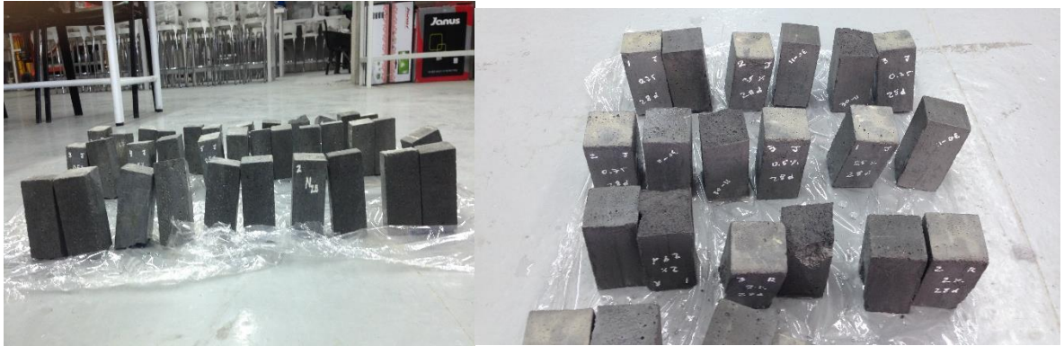
Figura 16. Trozos restantes de ensayo a flexión, para posterior ensayo a compresión.
