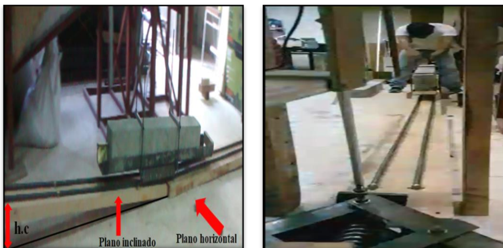
Figura 12: Carro cayendo por plano inclinado para alcanzar velocidad de impacto.
