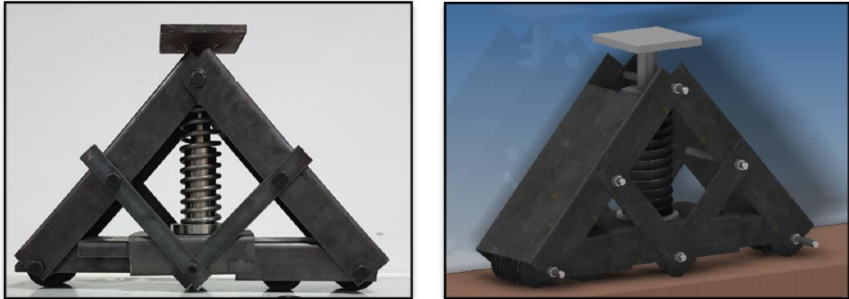
Figura 5: Comparación entre modelo concreto (izquierda) y diseño en inventor (derecha).
