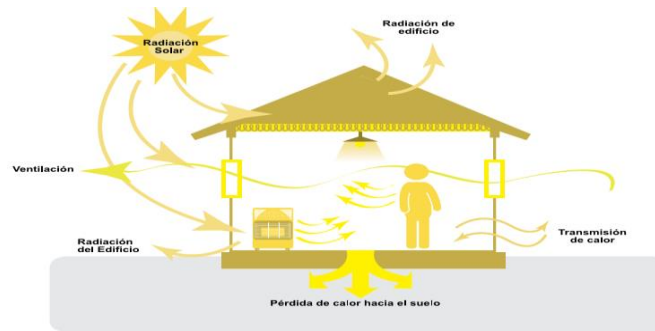
Figura N°3: Transferencia de calor en una edificación. Fuente: Manual acondicionamiento térmico criterios de intervención 7
