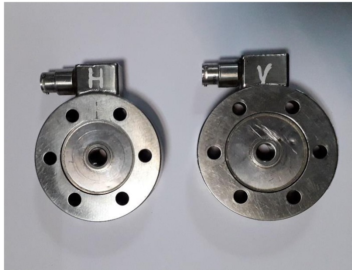
Figura 8. Celdas de cargas utilizadas para el ensayo de probetas. Fuente: Elaboración Propia.
