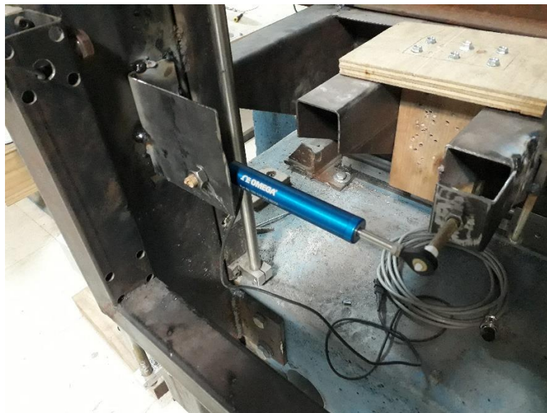
Figura 5. LVDT, Omega 5.6 cm de rango. Fuente: Elaboración Propia.
