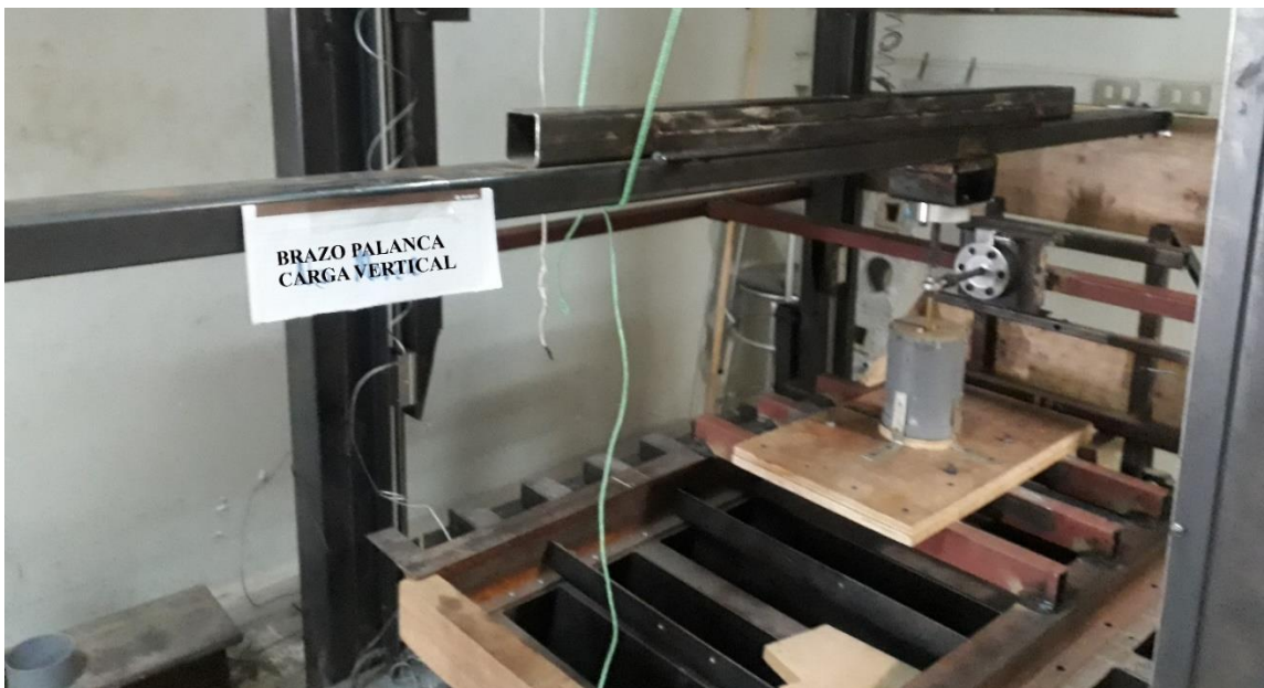
Figura 3. Esquema de aplicación de carga vertical. Fuente: Elaboración Propia.
