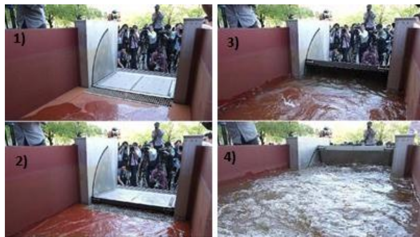
Figura 5.3: Funcionamiento de Compuerta (Fuente: http://blogs.lainformacion.com/futuretech/2013/06/04/puertas-aleta/ )
