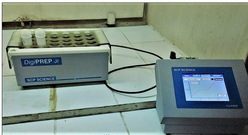
Figura 7: Digestión de las muestras con ácidos en el digestor, marca SCP SCIENCE modelo DigiPREP Jr. Facultad de Ciencias, UCSC.
