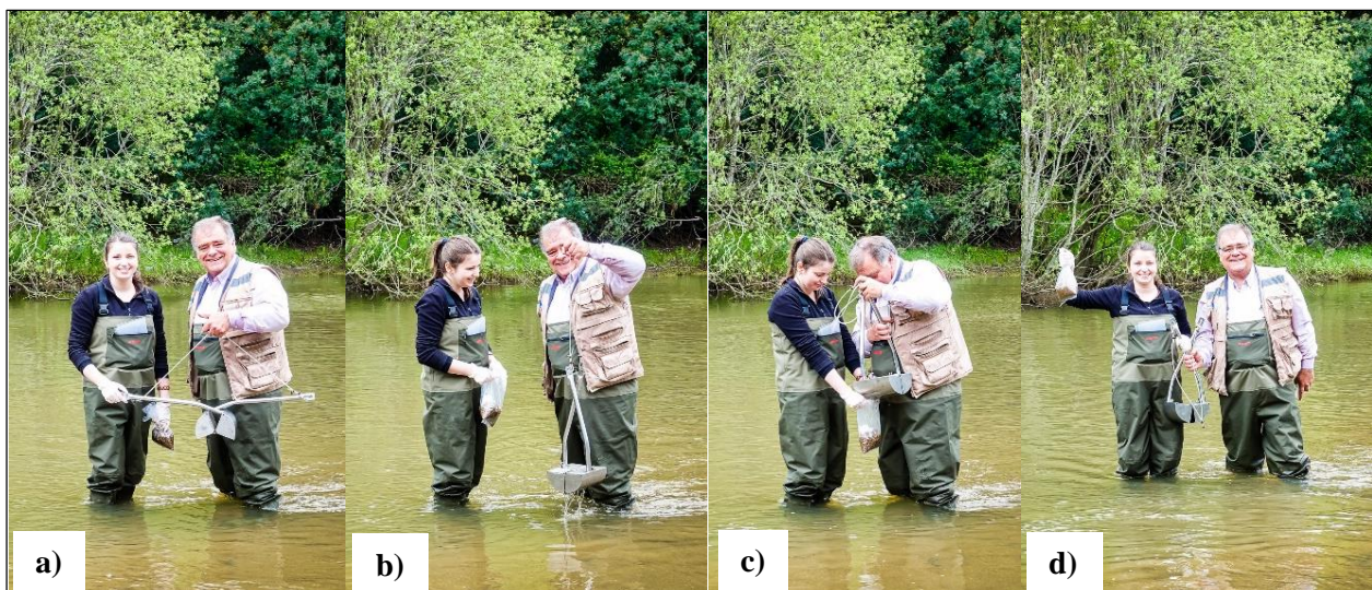
Figura 6: Secuencia de muestreo realizado en terreno (Coordenadas UTM: 695187 E – 5927766 S). a) posicionamiento de la draga, b) extracción de muestra, c) guardado de las muestras en bolsas de poliuretano y d) muestra lista para transporte.
