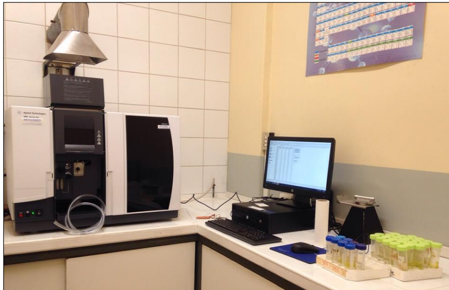
Figura 8: Equipo de espectrofotometría de absorción atómica, modelo 240 AA. Facultad de Ciencias, UCSC.
