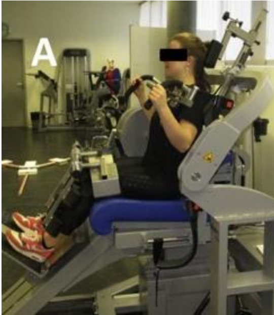
Fig. 1 Flexión y extensión de tronco utilizando dinamometría isocinética. (Roth et al., 2017).
