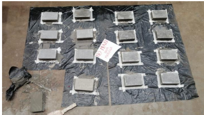
Figura 5: Refrentado a probetas a compresión.
