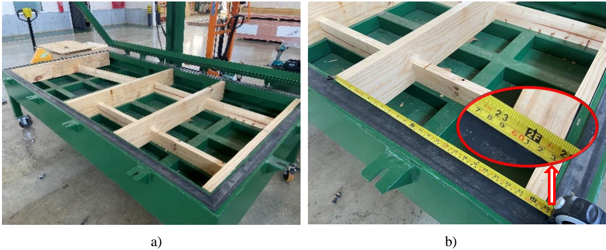
Figura B 21: Distribución de los apoyos a claro de luz 24" (61 cm). a) vista general b) vista específica.
