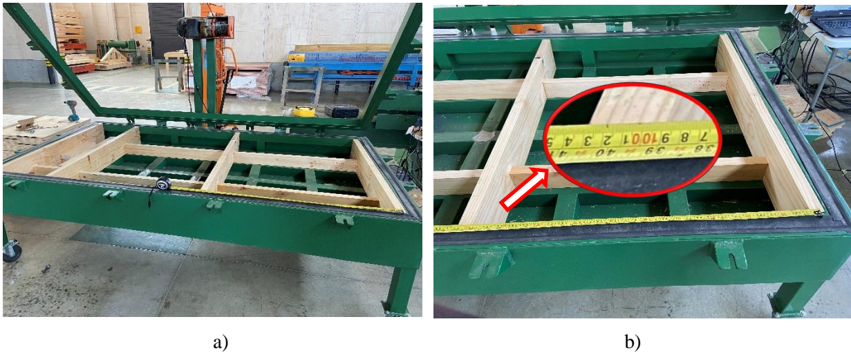
Figura B 25: Distribución de los apoyos a claro de luz 40” (102 cm). a) vista general b) vista específica.
