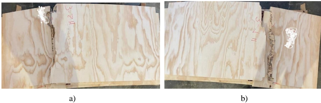
Figura B 3: a) y b) Probeta ensayadas en flexión vertical al eje de resistencia con falla en los costados
