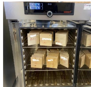
Figura 11: Ensayo de humedad. a) Muestras de ensayo. b) Secado en horno. Fuente: Elaboración propia (2024)
