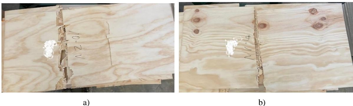
Figura B 4: a) y b) Probeta ensayadas en flexión horizontal al eje de resistencia con falla en el centro
