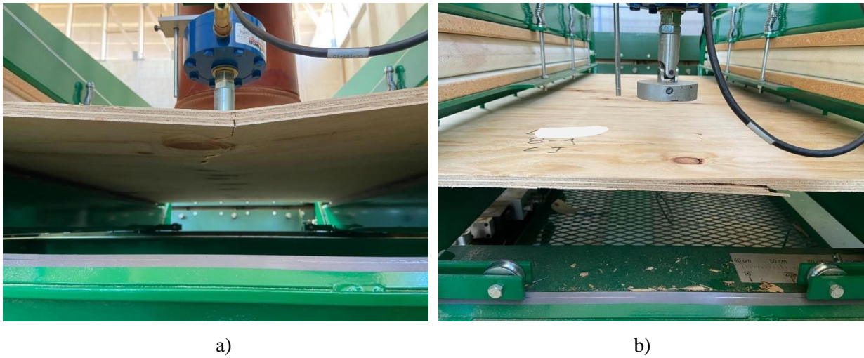
Figura B 26: Tipo de falla después de carga de impacto. a) Falla en la tras cara del tablero b) vista 2.
