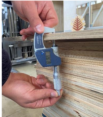
Figura 9: Medición de espesor con micrómetro. Fuente: Elaboración propia (2024)
