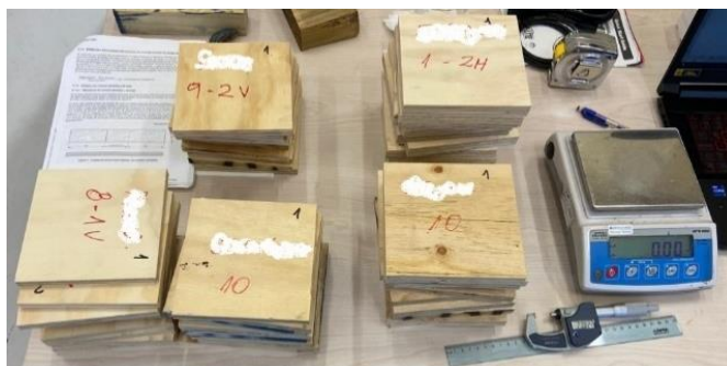
Figura 11: Ensayo de humedad. a) Muestras de ensayo. b) Secado en horno. Fuente: Elaboración propia (2024)
