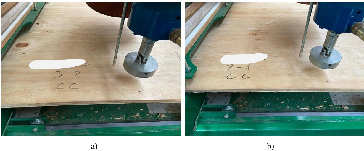
Figura B 26: Ensayo carga estática concentrada. a) vista 1 b) vista 2.
