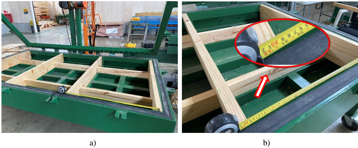
Figura B 23: Distribución de los apoyos a claro de luz 32'' (81 cm). a) vista general b) vista específica.
