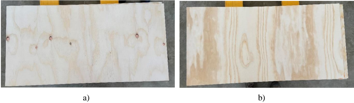
Figura B 1: a) y b) Probeta para ensayo de flexión horizontal al eje de resistencia
