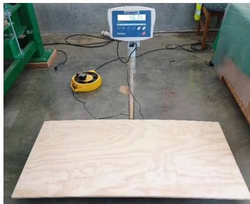
Figura 10: Medición de peso con balanza de sobre piso. Fuente: Elaboración propia (2024)
