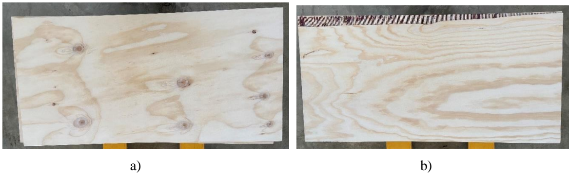
Figura B 2: a) y b) Probeta para ensayo de flexión vertical al eje de resistencia
