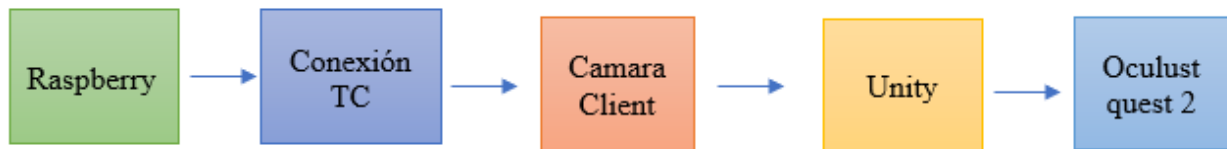
Fig. 4.3: Diagrama de flujo de conexión con la cámara. Fuente: Elaboración propia.
