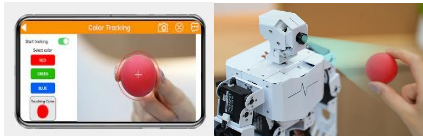
Fig. 2.10: Seguimiento de color en aplicación y demostración. Fuente: Hiwonder, 2024 [15]
