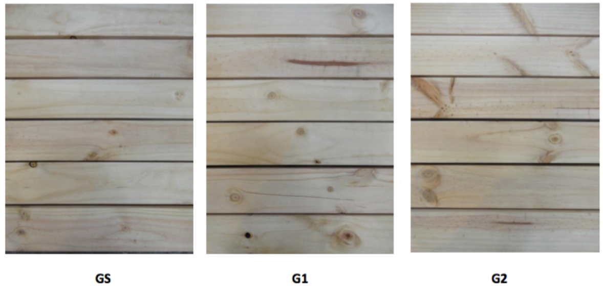
Figura 2.6: Apariencia de piezas de Pino radiata clasificadas en los grados estructurales de la NCh 1207. Fuente: Instituto Forestal.
