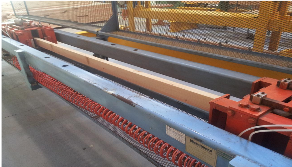
Figura 4.18: Aplicación de un ensayo de resistencia a la tracción paralela a las fibras.
