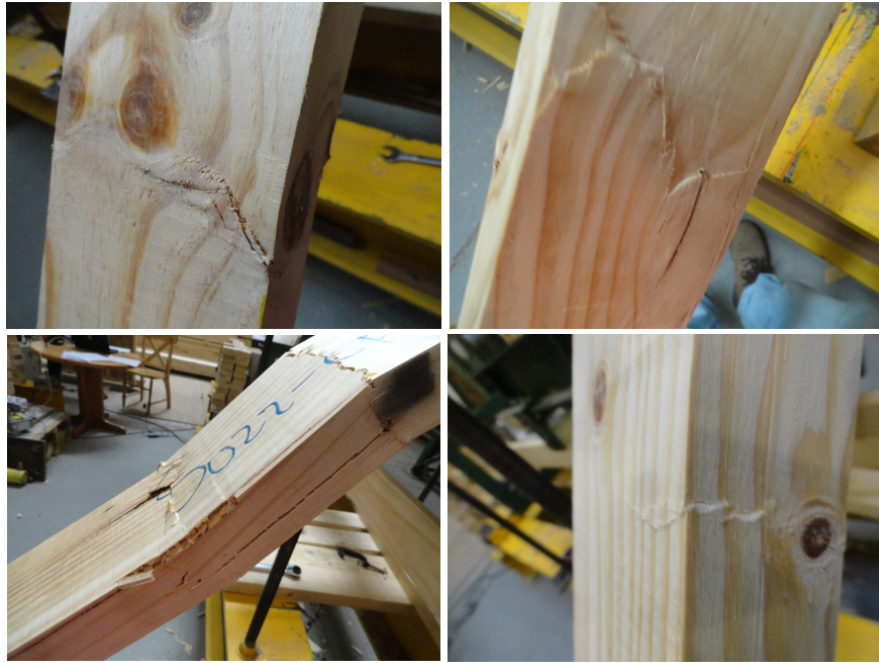
Figura 5.6: Fallas registradas en las probetas sometidas a compresión paralela a la fibra.
