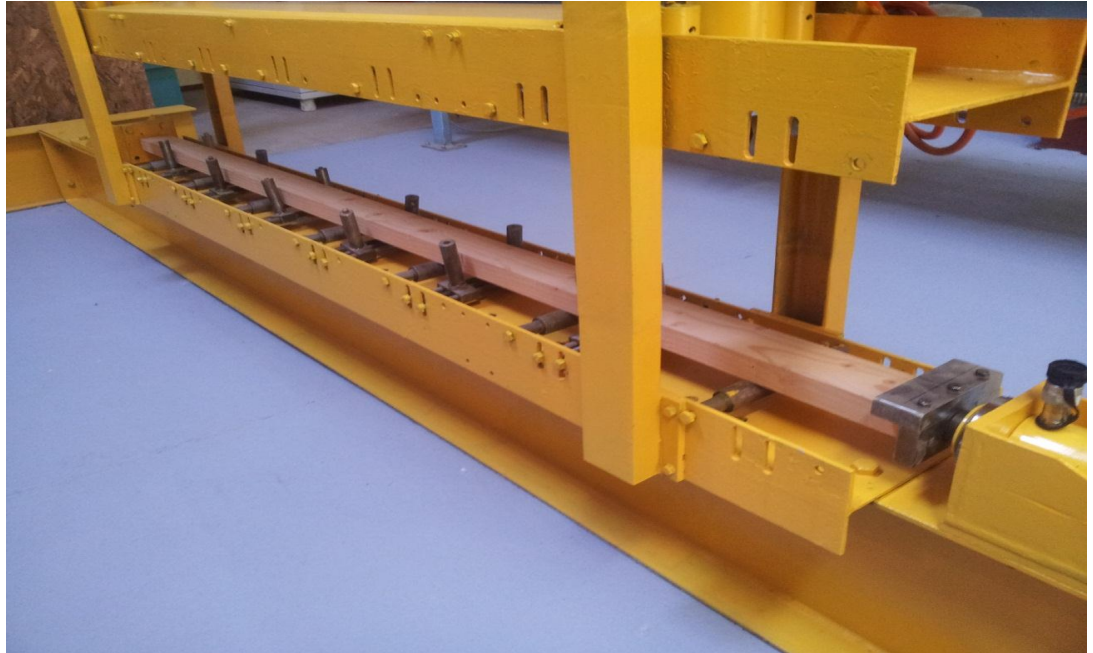
Figura 4.20: Aplicación de un ensayo de resistencia a la compresión paralela a las fibras.
