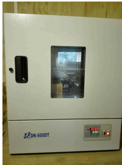
Figura 3.10: Horno Yih Der DK-600DT utilizado. Fuente: Elaboración propia, 2016.
