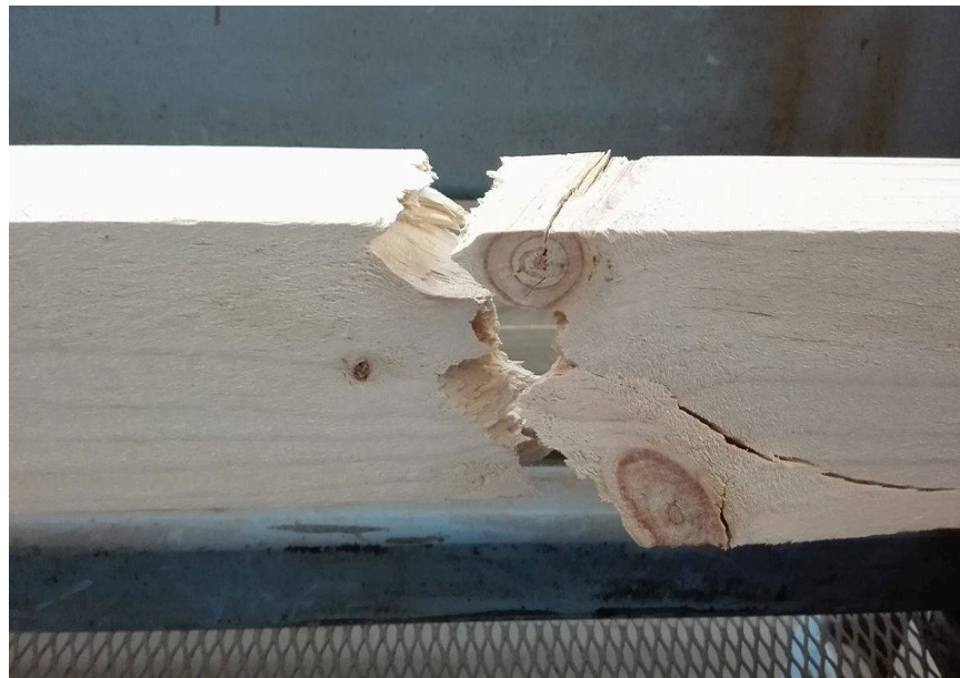
Figura 5.10: Falla registrada en las probetas sometidas a tracción paralela a la fibra.
