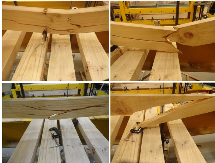
Figura 5.4: Fallas registradas en las probetas sometidas a flexión paralela a la fibra.
