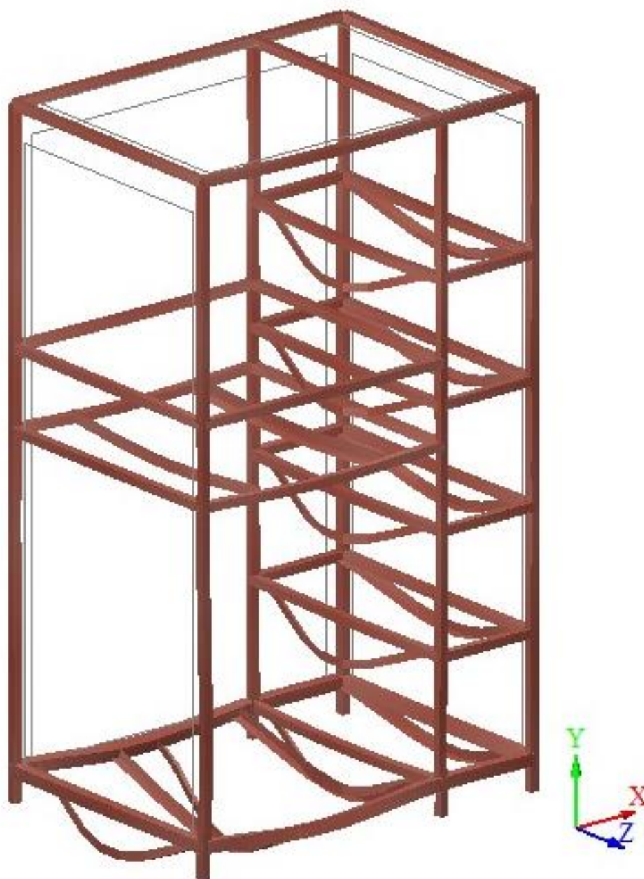
Figura 33: Deformada gabinete C2 Tipo A, suelo D.
