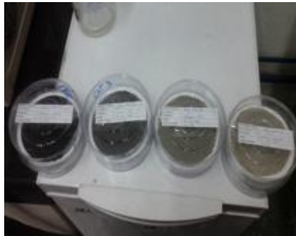
Fig. 5: Filtros recuperados posterior al ensayo (Imagen obtenida del Laboratorio Área Combustibles CCP y Certificación de Productos, CESMEC S.A. Empresa BUREAU VERITAS. Concepción, Chile)
