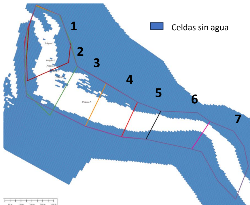
Figura 17. Variación de polígonos para obtención de área de la superficie del agua para el prisma mareal
