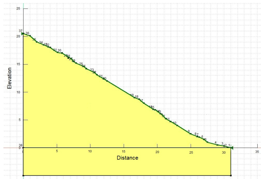
Figura 14: Perfil longitudinal obtenido en la ladera (Fuente: Elaboración propia).
